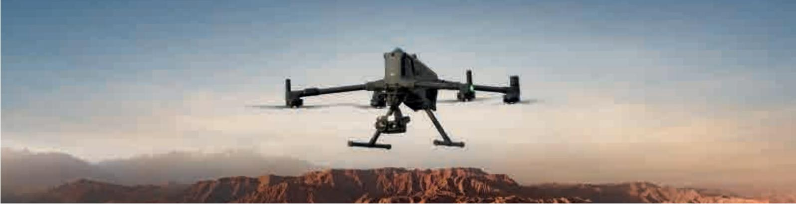
El DJI Matrice 400 es un dron empresarial de alto rendimiento con capacidades avanzadas de inteligencia artificial, incluyendo detección de obstáculos, seguimiento automático y mapeo de alta precisión. Destaca por su tiempo de vuelo prolongado, hasta 59 minutos con la carga útil del Zenmuse H30T, y su capacidad para transportar cargas útiles de hasta 6 kg.
